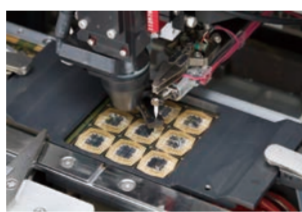
半導体のアセンブリ(組立)に使用されるカイジョー製ワイヤボンダ
